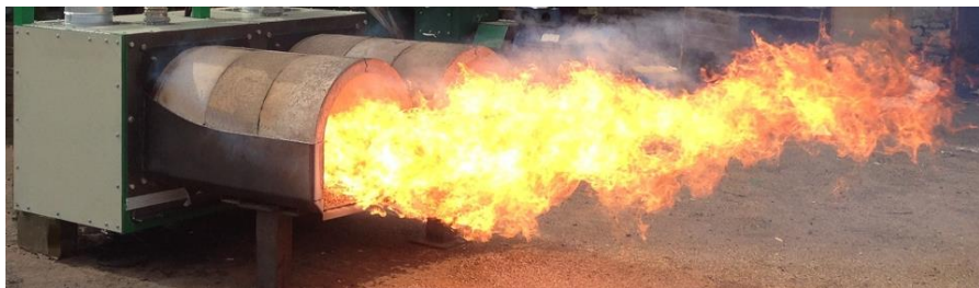
Предотгрузочные и испытания горелки 2000 кВт на гранулах из лузги подсолнечника.
