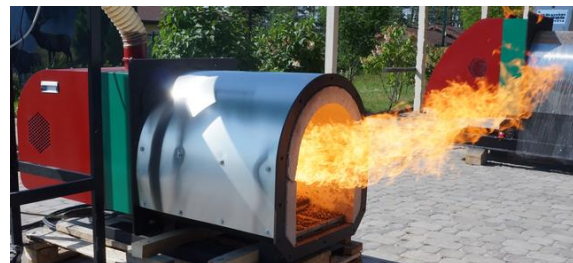
Испытания горелки 500 кВт
