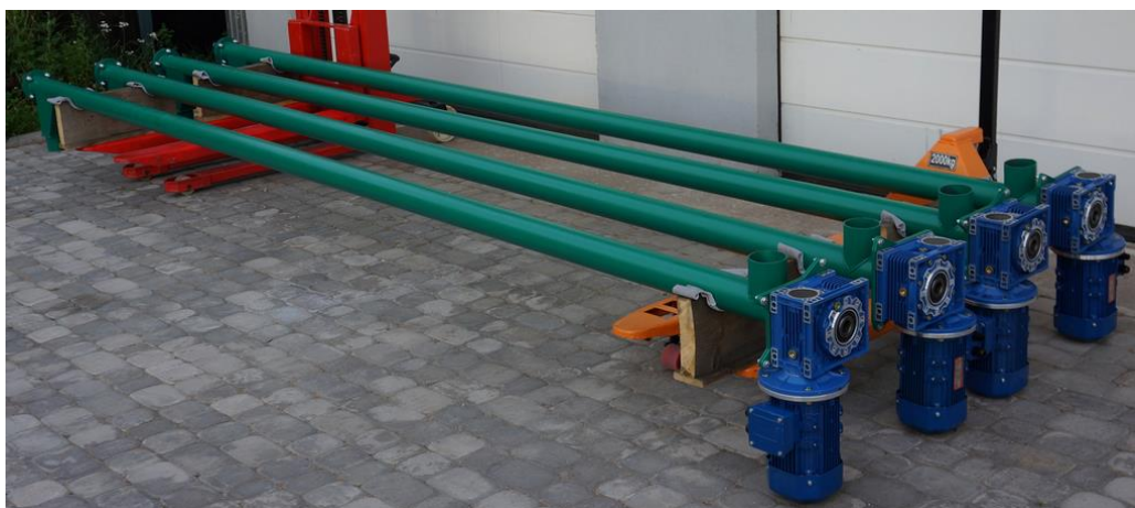
безосевые шнеки для подачи гранул к горелкам
